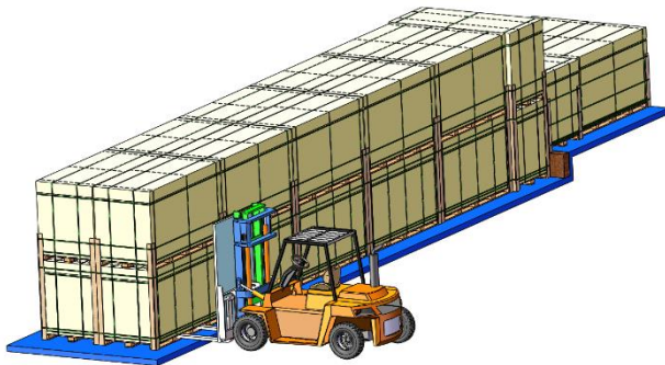
短辺縦型、U型梱包のフォークリフトによる荷卸しのイメージ図
