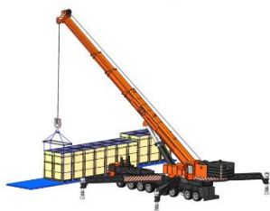
長辺縦型のクレーンによる荷卸し図
