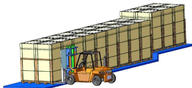
長辺縦型のフォークリフトによる荷卸しのイメージ図
